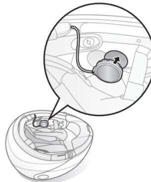
6. Inserte los botones de control y la unidad del micrófono entre la carcasa externa y la carcasa interna izquierda. Pase el cierre por el soporte de cierre hasta que haga clic.
