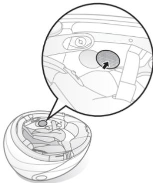
5. Pegue los altavoces a las sujeciones con cierre autoadherente de bucle para altavoces en el interior del casco. A continuación, pase los cierres por los soportes de cierre hasta que hagan clic.
