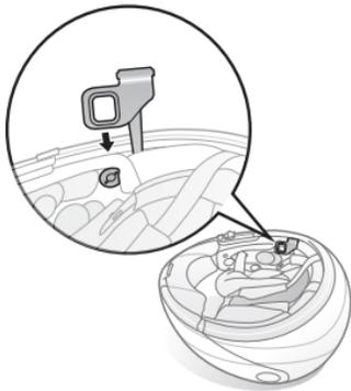
3. Inserte la unidad principal entre la carcasa interna y la carcasa externa. Alinee los soportes de cierre con los cierres traseros.
