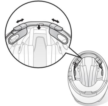
4. Retire cada cubierta de la sujeción con cierre autoadherente de bucle para los altavoces para que quede expuesta la superficie adhesiva. A continuación, instale las sujeciones en los bolsillos para las orejas del interior del casco.
